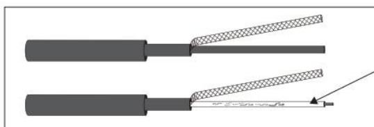
提示:如用户自行拨线接线,加长电缆或缩短电缆,注意将透明线外的黑色导电外皮拨除干净,防止与电极参比端产生短路现象可使用万用表检查,请使用 pH/ORP 专用线缆连接。
