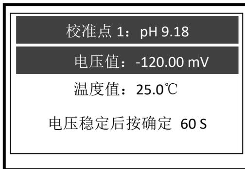
第 1 点校准结束后，将电极置于蒸馏水或去离子水内清洗，用无纺布或干纸巾吸干电极表面水分，注意此过程中不要触碰到电极头部的球泡，防止球泡破裂。然后将电极置于下一标液内开始第 2 点校准。
